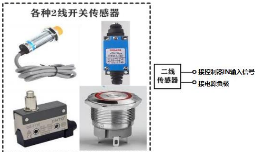
两线传感器接线方式
